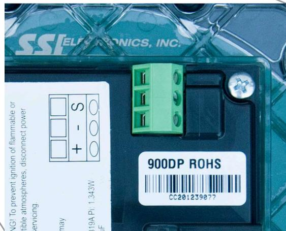
Alimentación auxiliar y conexión del generador de impulsos al medidor. Observe las tres conexiones: CC+, CC- y la señal del generador de impulsos.
