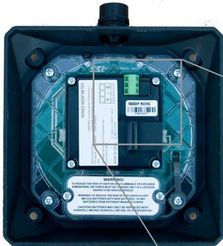
Los tres cables que entran al medidor solo deberían estar limitados, tanto como fuera necesario, a completar el cableado. **No se debería dejar exceso de cableado dentro del medidor.**
