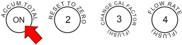
3. Presione el botón (2) para guardar y volver al modo de funcionamiento normal.
